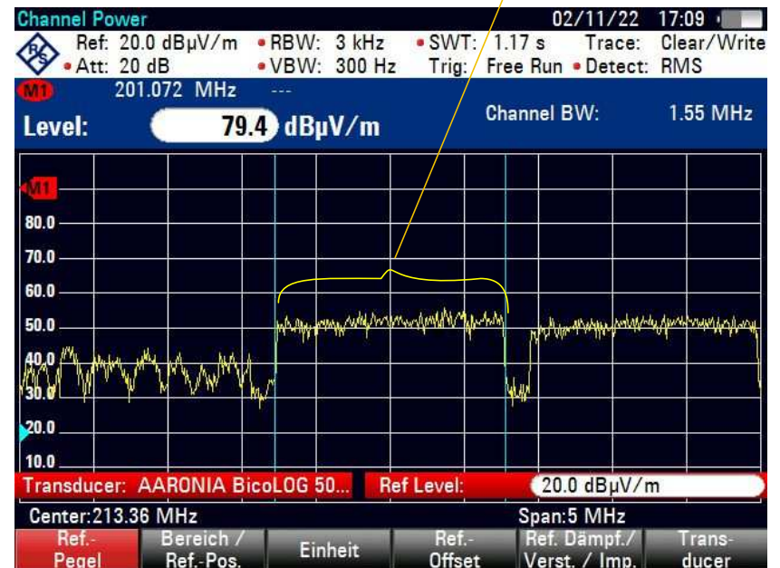
Tx Ensemble 10C Messung Feldstärke 8m Luftabstand / Mesure du l'ensemble 10C Tx Intensité de champ à 8m de distance dans l'air
